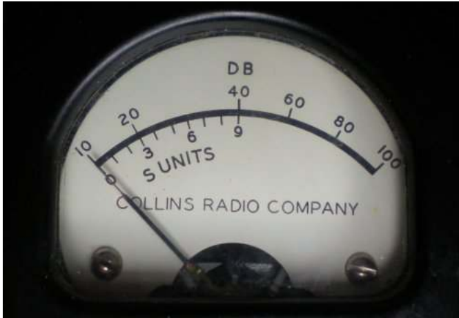
Bild 4. S-meter på Collins 75S-3B mottagare tillverkad 1963-1975.
