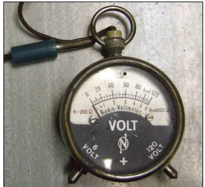
Gammal Voltmeter i fickursutförande! Observera den inre resistansen på 200 resp. 4000 Ohm!
